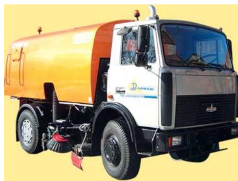
Рис. 6.4. Вакуумная подметально-уборочная машина ВПМД-01.
