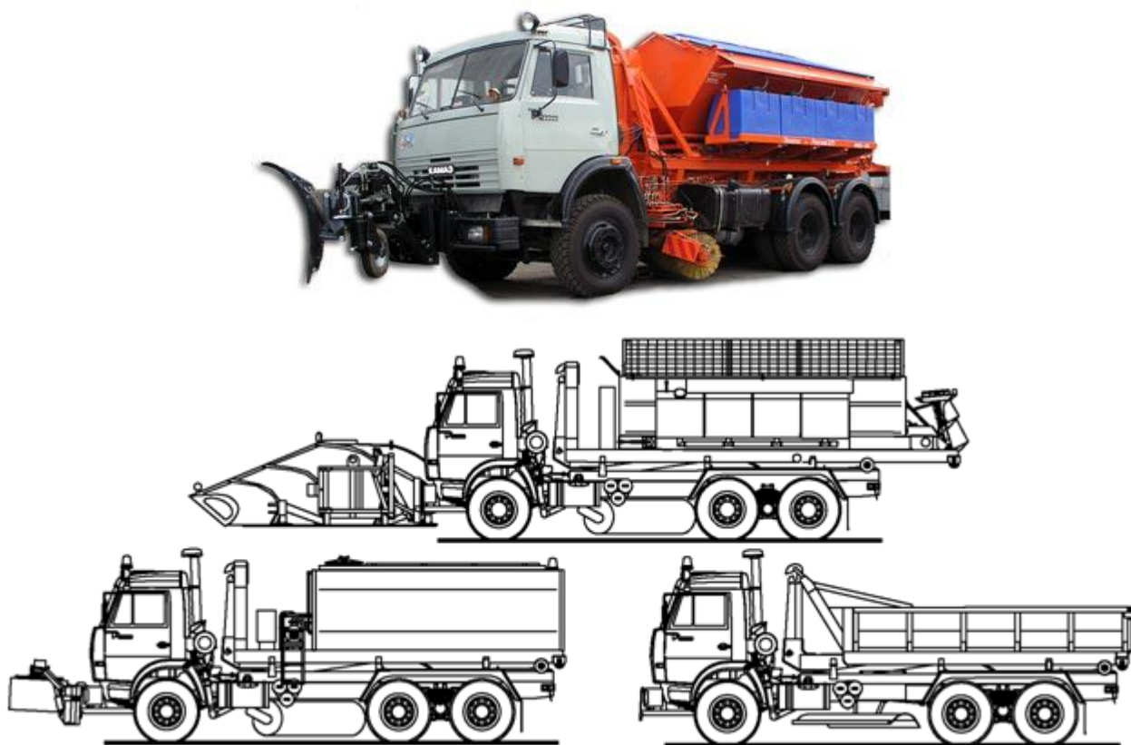
Рис. 6.5. Комбинированная машина МКДС-4107.
