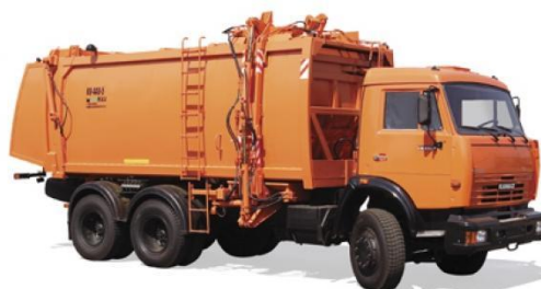
Рис. 4.44. Мусоровоз с боковой загрузкой КО-440-5 на базе шасси КАМАЗ 65115
