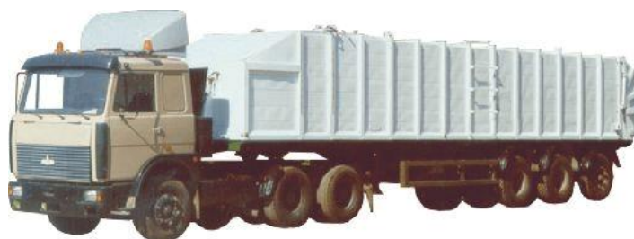
Рис. 4.35. Мусоровоз МКТ-150 на шасси МАЗ
