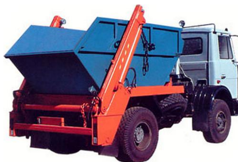
Рис. 4.46. Бункеровоз МКС-3501 на шасси МАЗ-5551А2
