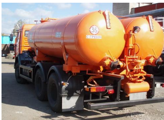
Рис. 5.2. Вакуумная машина КО-505А на шасси КамАЗ-65115-71
