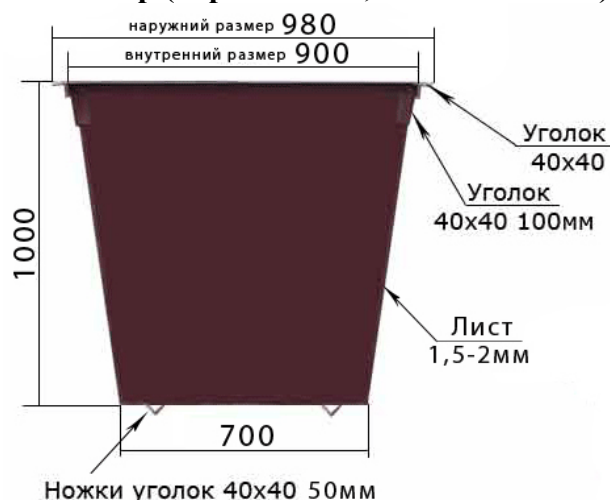
Рис. 4.22. Стандартные металлические контейнеры емкостью 0,75 м³
